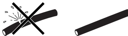
Kontrollera maskinen med avseende på läckage
