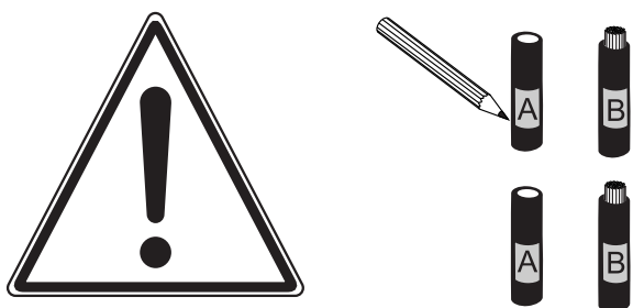
Märk kablar och slangar
