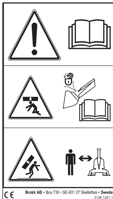
Varnings- och informationsdekal, monterad på Brokk skopa.
